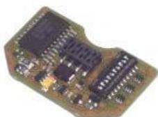
Модуль адресации SUX5000 AP служит для адресации безадресных устройств (датчиков давления, датчиков уровня, датчиков утечки и т.п.) в составе адресного шлейфа с протоколом связи LoopAP. Модуль также позволяет обеспечивать контроль целостности шлейфа до адресуемого устройства.
